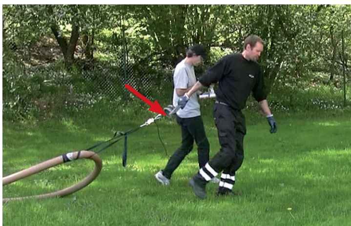
Figur 3 | Dynamometer typ Lutron FG-5100 som användes vid slangdragningsförsök. Kraftgivaren finns i mitten på "S:et" i den vänstra bilden och vid pilen på den högra bilden. Slang och draghandtag krokas fast vid ögla/krok och kraften registreras kontinuerligt på display-enheten som bärs av försöksledare.
