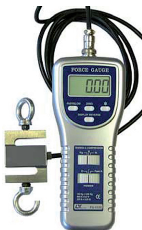
Figur 3 | Dynamometer typ Lutron FG-5100 som användes vid slangdragningsförsök. Kraftgivaren finns i mitten på "S:et" i den vänstra bilden och vid pilen på den högra bilden. Slang och draghandtag krokas fast vid ögla/krok och kraften registreras kontinuerligt på display-enheten som bärs av försöksledare.
